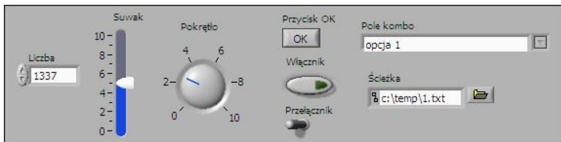
Rys. 6.25 Przykład kontrolki umieszczanych na panelu frontowym programu
