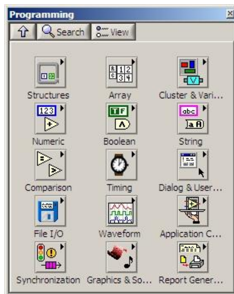
Rys. 6.31 Paleta podstawowych funkcji do budowy aplikacji w LabVIEW
