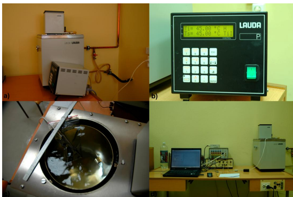
Rys. 6.46 Stanowisko pomiarów kalibracyjnych: a) ultratermostat, b) sterownik c) cylinder z umieszczonymi czujnikami temperatury d) komputer z uruchomioną aplikacją
