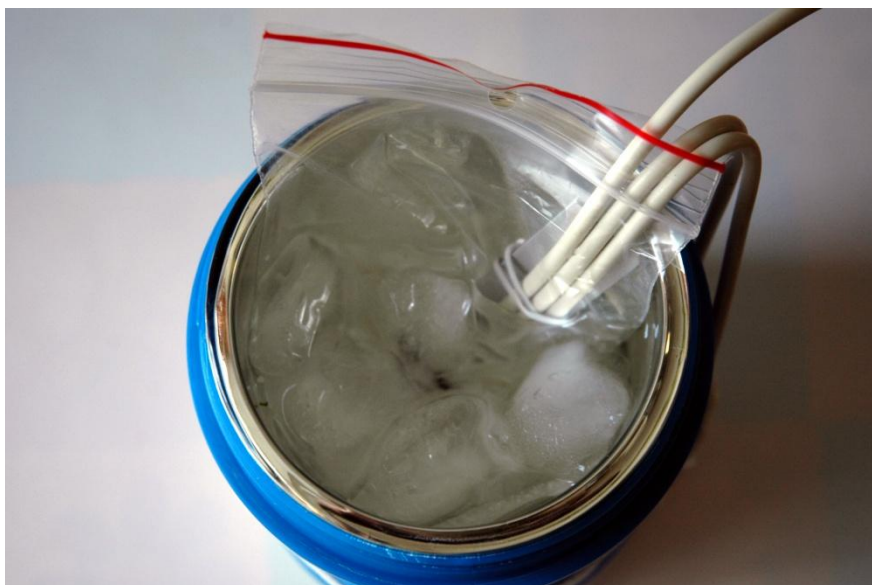
Rys. 6.47 Zanurzone w termosie czujniki temperatury
