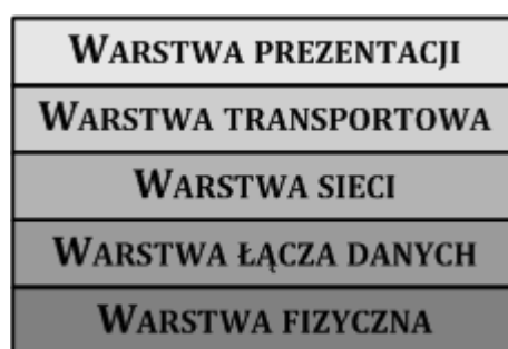
Rys. 4.12 Warstwowa architektura protokołu sieciowego 1-Wire
