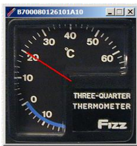
Rys. 6.17 Przykładowy wskaźnik analogowy programu Thermometer
